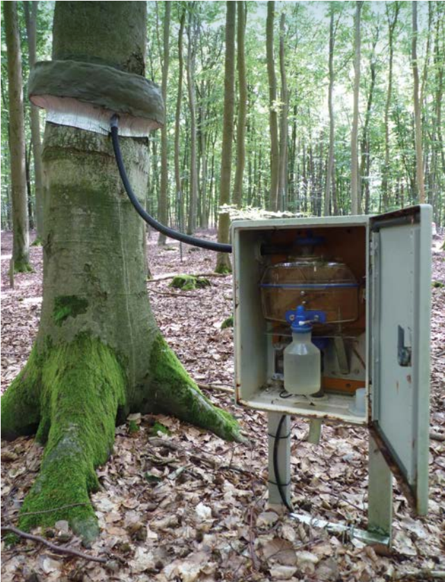
Abbildung 10: Stammabflussmessungen auf der Level-II-Fläche Sandhof, Mecklenburg-Vorpommern
