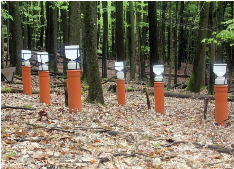
Abbildung 9: Depositionssammler auf der Level-II-Fläche Fischbach, Saarland. Depositionsmessungen sind ein zentraler Bestandteil des Level-II-Monitorings. Mithilfe der Trichter wird der Niederschlag im Freiland oder unter den Baumkronen aufgefangen und regelmäßig auf Schwefel- und Stickstoffgehalte sowie weitere Stoffe untersucht.
