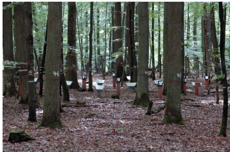
Abbildung 1: Streufallmessung (rechteckige Behälter), Depositionsmessung und Umfangmessbänder der Level-II-Fläche Merzalben, Rheinland-Pfalz
