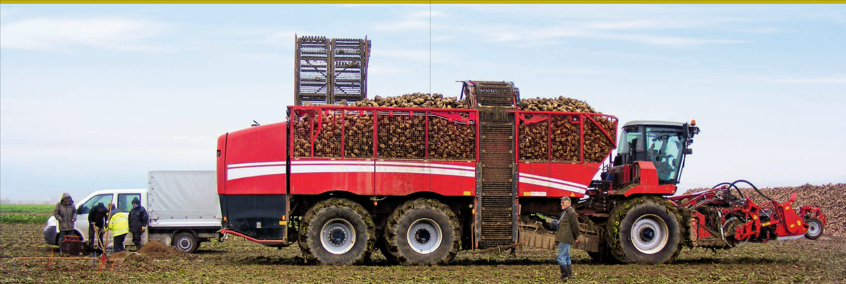
Bei den Versuchen auf dem Acker kam auch ein sogenannter Rübenroder zum Einsatz: Die schwere Landmaschine ist mit dicker Bereifung ausgestattet, um den Druck auf den Boden zu verteilen.
