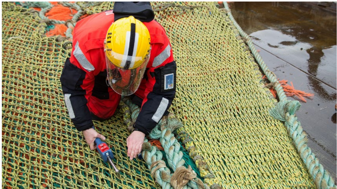
Abb. 5: Kontrolle der Netz-Maschenweite durch die Fischereiaufsicht der Bundesanstalt für Landwirtschaft und Ernährung (BLE). Bildquelle: BLE
