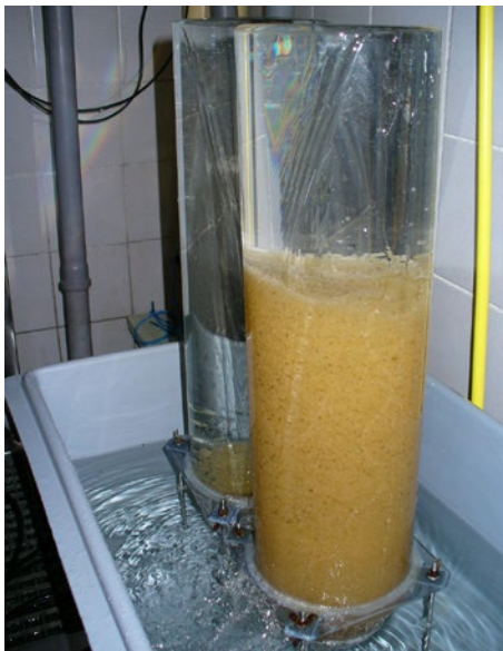
Abbildung 14: Zugerläser in denen Eier der Nase ( Chondrostoma nasus ) erbrütet werden. Bildquelle: BLE
