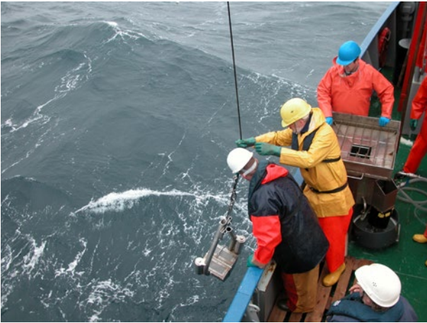
Abbildung 2: Ein Benthos-Greifer wird für eine Bodenprobe ins Meer hinabgelassen. Bildquelle: BLE
